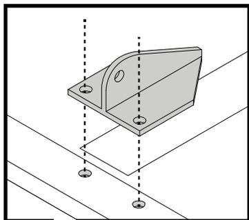
Сначала переверните SkyRise™ чтобы он опирался на зажимы. Затем найдите предварительно просверленные отверстия под наклейками у края и удалите наклейки.
