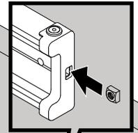
Вставьте 2 квадратные гайки в каждое крепление и совместите крепления с предварительно просверленными отверстиями в полу палатки. Обратитесь к шагу 2 для ориентации.
